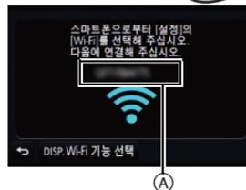
[Wi-Fi 암호] 가 디폴트 설정 [OFF] 로 설정되어 있을 경우에는 제 3 자가 Wi-Fi 무선 전파를 방해하고 통신 내용을 도용할 수 있습니다 . [Wi-Fi 암호] 를 [ON] 으로 설정하여 패스워드 사용을 가능하게 하십시오 .
